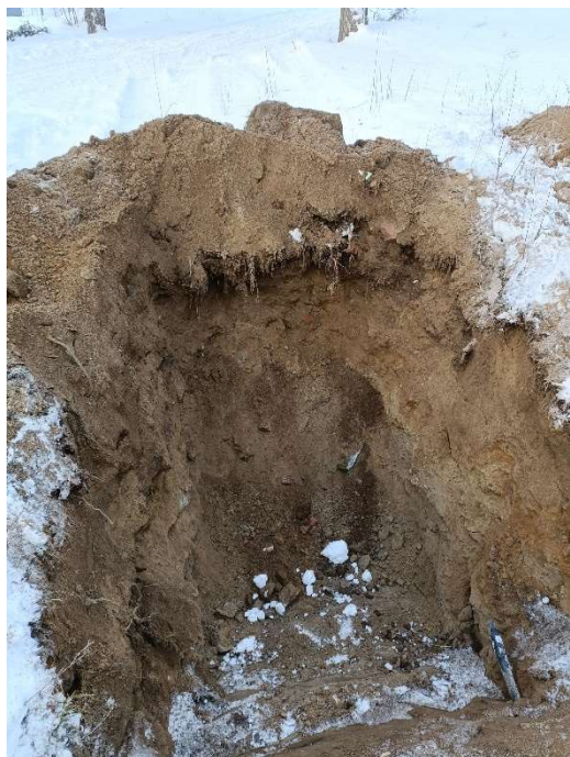
Kuva 7. Tutkimuspiste SW7. Tutkimuspisteessä havaittiin muuta yksittäinen muovin- ja betoninpalanen n. 1 m syvyydellä.
